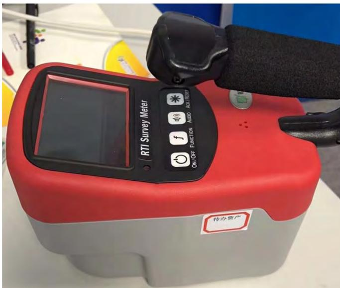
已购置的瑞典产 RTI 型 Survey Meter（辐射剂量率仪）
