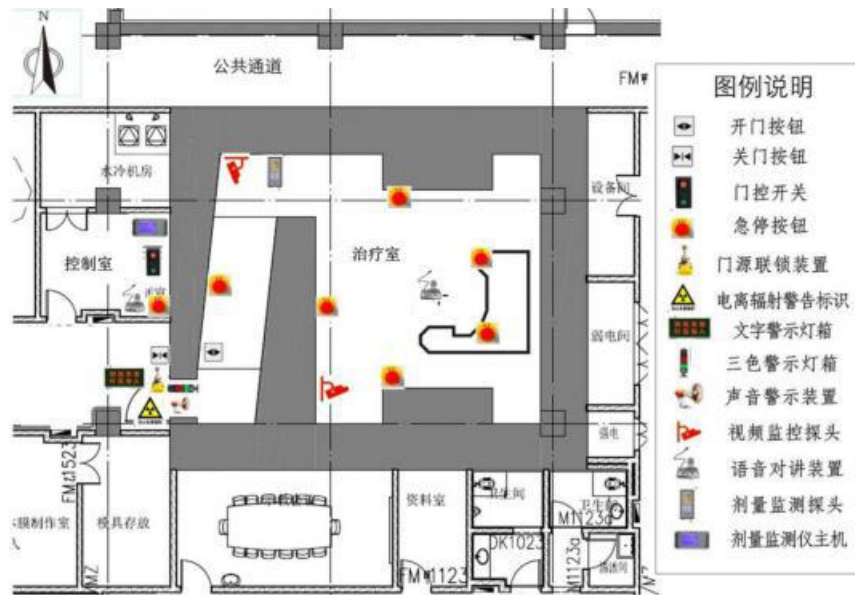
图 10-3 加速器机房安全措施布置建议图
