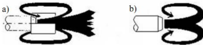
图 6.2-3 烟气内循环示意图 (a.再循环罩, b.射流卷吸)
